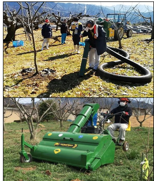
写真2 収穫機実演の様子 (上)トラクター装着式収穫機(ホースによる吸引) (下)自走式収穫機(ブラシによる搔込)
